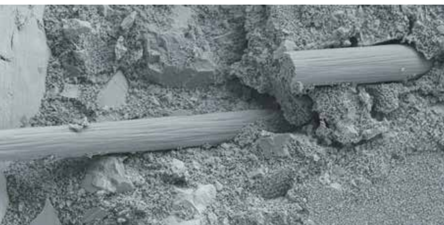
Koolstofvezel onder de rasterelektronenmicroscop
